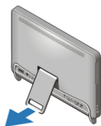
Figura3. Instalação do suporte posterior
